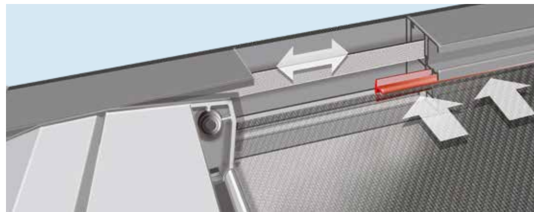
Das Dachtuch wird durch die anhaltende Spannung der ZIP-Screentechnologie stramm an die Führungen gezogen. Perfekte Tuchspannung.
